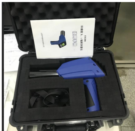
照片 10 辐射防护监测仪
